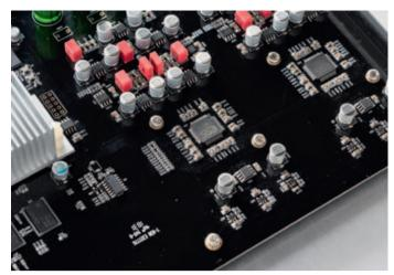
Der T2 enthält zwei DAC-Chips ES9028Pro Sabre. Jeder dieser DACs kann acht Kanäle wandeln, der Dual-Monobetrieb wirkt sich positiv auf das Rauschen aus, das mit 122 dBA sehr niedrig ausfällt.
